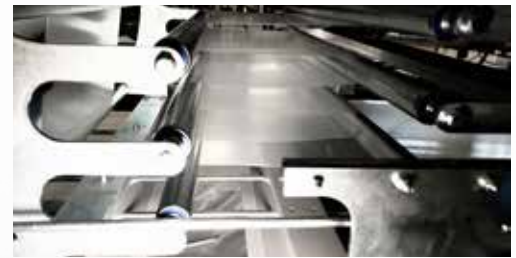
La unidad de tensado asegura un lanzamiento preciso incluso al final de la bobina.
